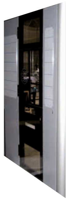
Trennwandtüre mit Werbeflächen und Wartungsklappe Bombardier
